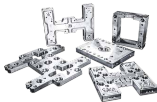
Auszug von Heißkanal-Verteilersystemen und Werkzeugplatten, die auf Hermle-Bearbeitungszentren in 5-Achsen-Technologie allseitig und inklusive Tieflochbohren komplett bearbeitet werden
