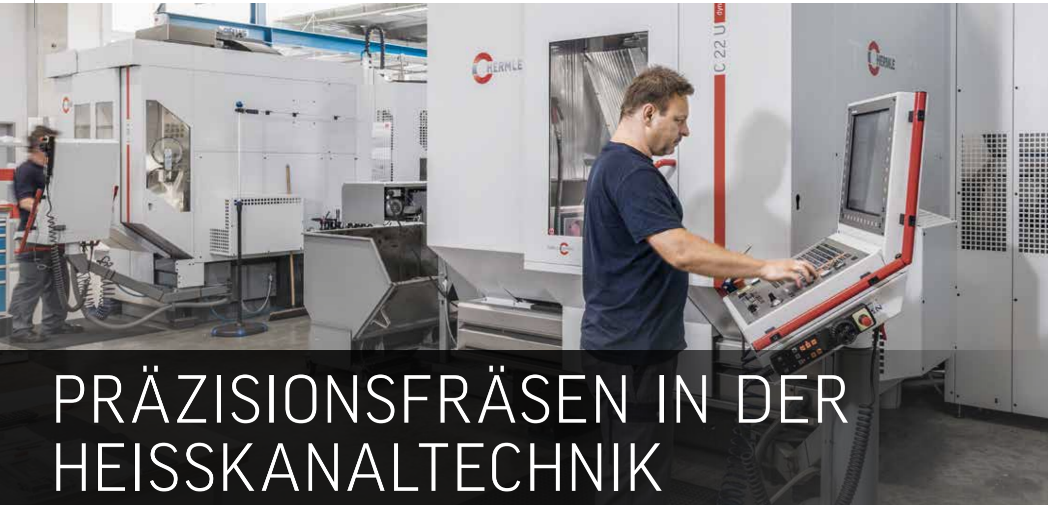
Das 5-Achsen-Bearbeitungszentrum C 22 U mit dem Zusatzmagazin ZM 43 für weitere 43 Werkzeuge (hinten rechts), betreut vom Fräser und Programmierer Stefan Heilek von GÜNTHER Heisskanaltechnik GmbH
