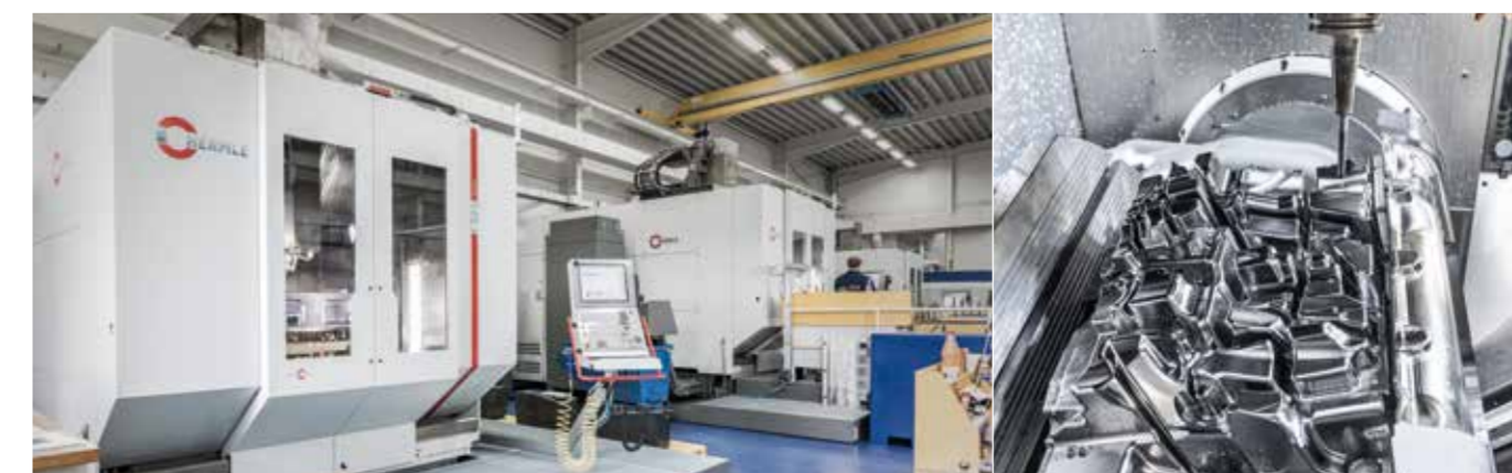
links Das neue 5-Achsen-CNC-Hochleistungs-Bearbeitungszentrum C 52 U rechts Arbeitsraum des C 52 U mit dem NC-Schwenkrundtisch mit 700 mm Durchmesser und für Traglasten bis 2.000 kg; hier bestückt mit einem großformatigen Grundwerkzeug, das 5-achsig Finish-bearbeitet wird
