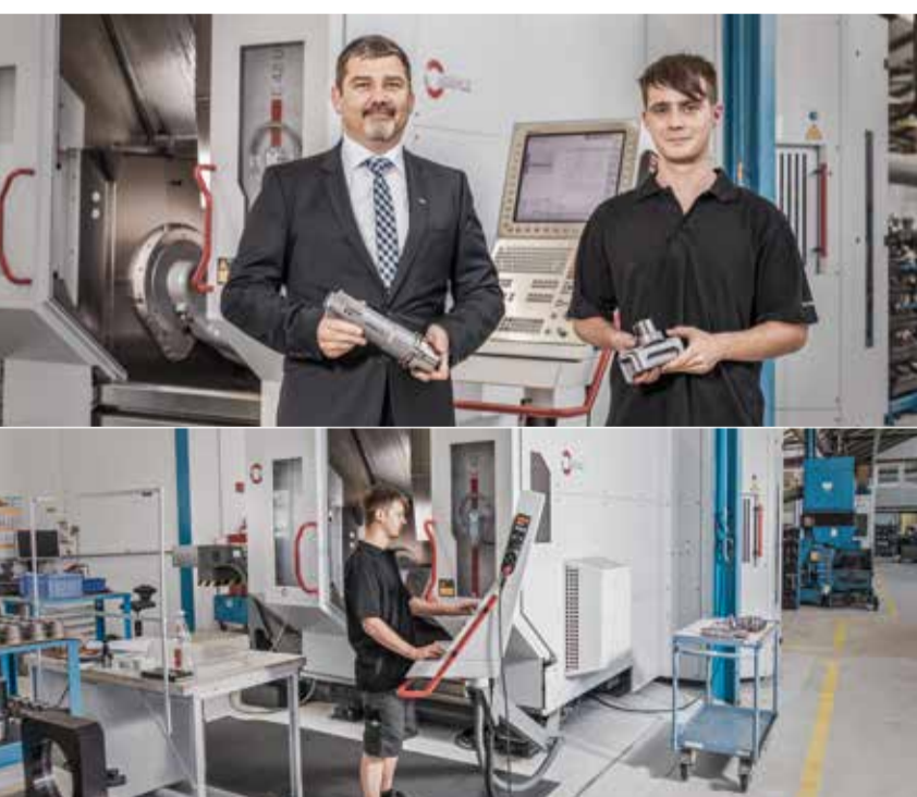
oben, von links Hans Binder, Leiter Geschäftsbereich Präzisionswerkzeuge, und rechts Matthias Deuschle, Programmierung/Bedienung, vor dem 5-Achsen-Bearbeitungszentrum C 42 U unten Das neue 5-Achsen-Bearbeitungszentrum C 42 U mit Zusatzmagazin ZM 50 in der Werkzeug-/Sonderwerkzeug-Fertigung von Wilhelm Bahmüller Maschinenbau-Präzisionswerkzeuge GmbH im Stammhaus in Plüderhausen
