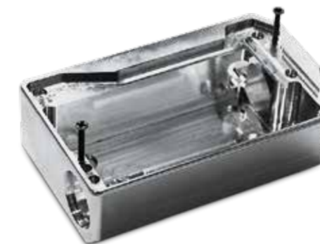
Ein anspruchsvolles Stahl-Werkstück, das auf einem Bearbeitungszentrum C 42 U in 5-Achsen-Technologie in wenigen Aufspannungen komplett gefertigt wurde
