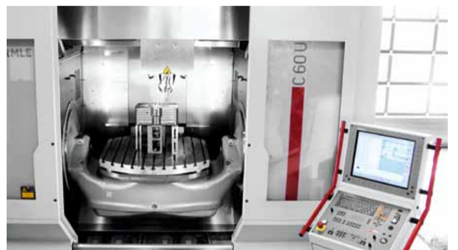
Gesamtansicht eines von zwei 5-Achsen-CNC-Hochleistungsbearbeitungszentren C 60 U von Hermle mit einem Arbeitsbereich von 1.200 x 1.300 x 900 mm (X, Y, Z), 70-Plätze-Werkzeugmagazin und Heidenhain-Steuerung iTNC 530.
