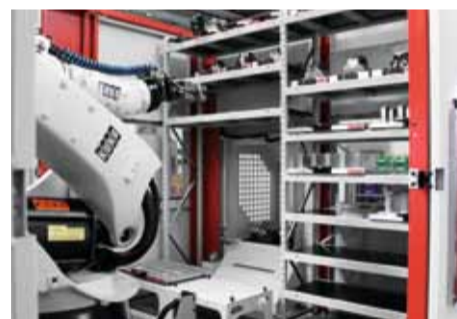
Robotersystem RS2 mit einem Teil der Schwerlastregale zur Aufnahme von Paletten mit unterschiedlichen Aufnahmehöhen; links unten: die rückseitige Öffnung des Rüstplatzes.
