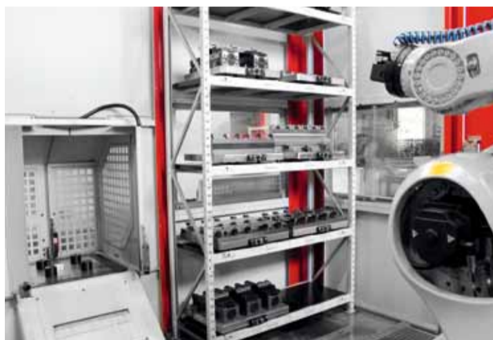
Flexibles Fertigungssystem als integrierte Einheit mit einer bereits aktiven C 40 U (re.) und dem Werkstückmagazin- und Handlingsystem RS2 (li.); vorbereitet zur anstehenden Integration einer weiteren, links vom RS2 aufgestellten C 40 U.
