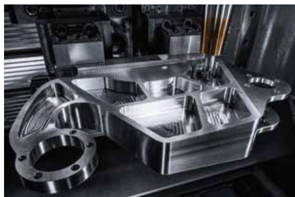
oben Hermle setzt bei der Bearbeitung von Titan wie bei diesem Strukturteil auf die Aerosol-Trockenschmierung.
