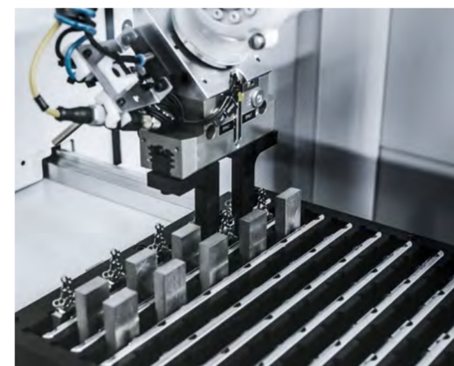
Eine von Medartis selbst konstruierte Werkstück-Palette mit Vielfach-Aufnahmen für die Bereitstellung von Titan-Rohlingen bzw. die Aufnahme von Fertigteilen, wobei das Handling durch den Roboter komplett automatisiert ist.
