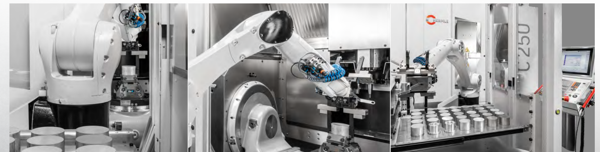
Robotersystem RS 05-2 adaptiert an ein 5-Achsen Bearbeitungszentrum C 250 der Performance-Line-Baureihe.
