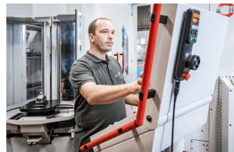
Die Steuerung kommt von Heidenhain (Typ TNC 640) und ist dank HSCI-Schnittstelle und EnDat-Interface durchgängig digital.
