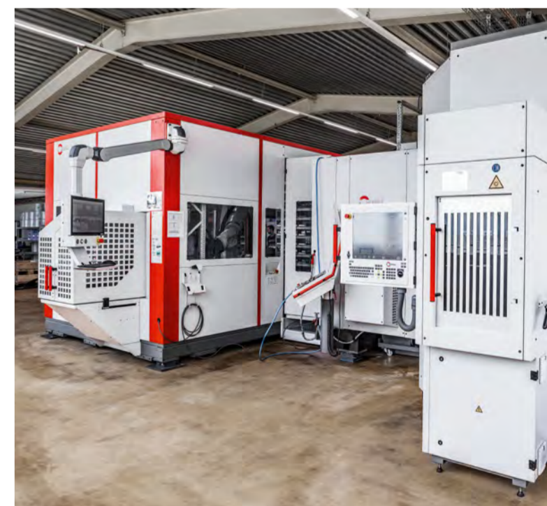
Die hochproduktive flexible Fertigungszelle C 22 U mit Robotersystem RS 2 (links) und dem Werkzeug-Zusatzmagazin ZM 192.
