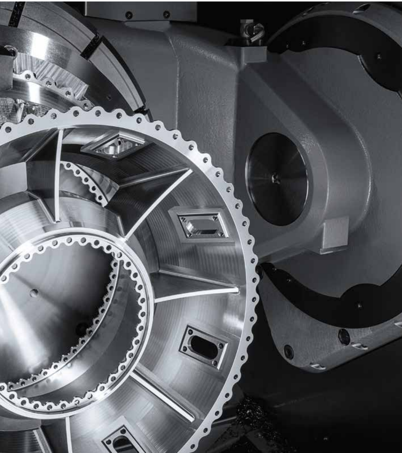
Hermle C 42 U MT dynamic in 5-Achs-Mill/Turn-Ausführung | Bearbeitung eines Triebwerksgehäuses für die Luft- und Raumfahrt.
