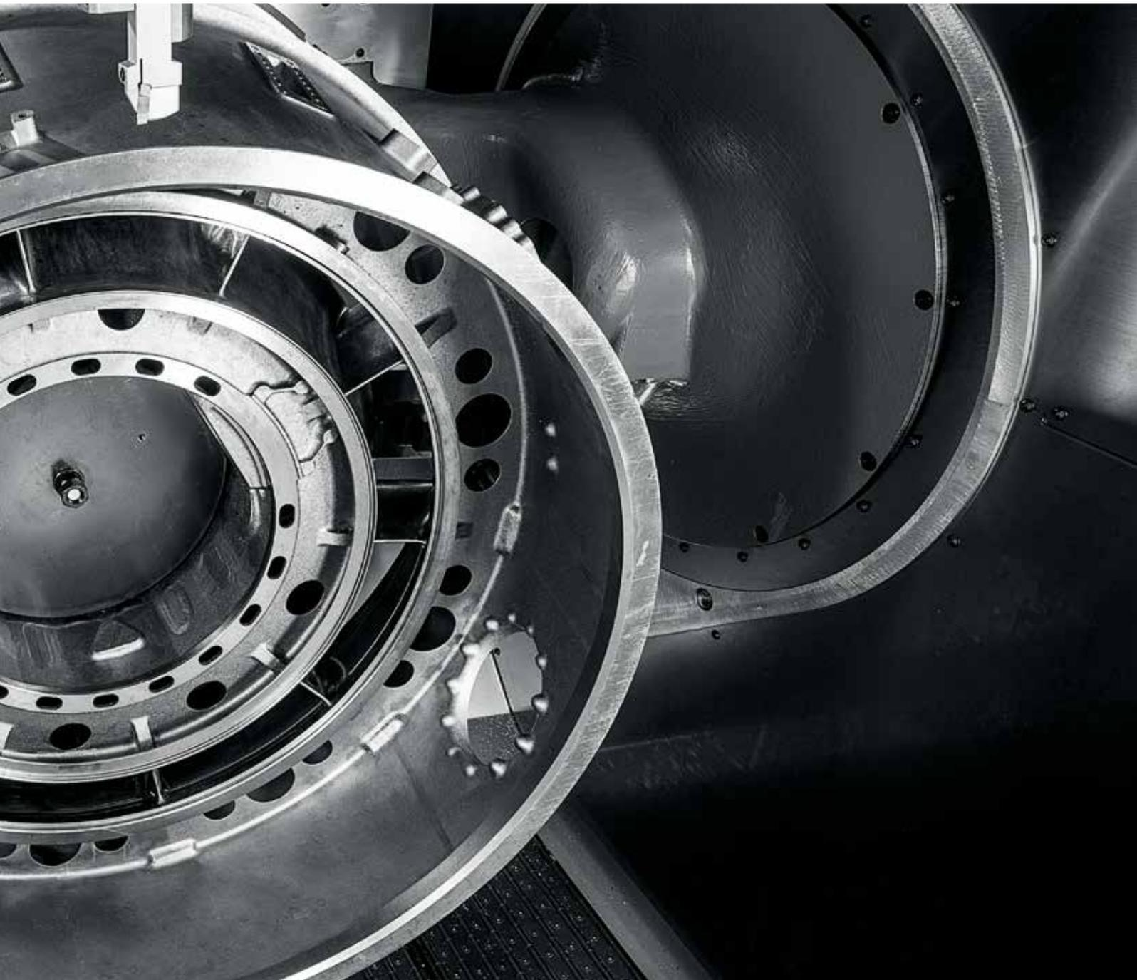
Luft- und Raumfahrttechnik. Triebwerksgehäuse aus Titan.
