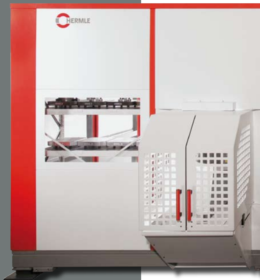
Robotersystem RS 2 adaptiert an eine C 40 U dynamic mit Werkzeug Zusatzmagazin
