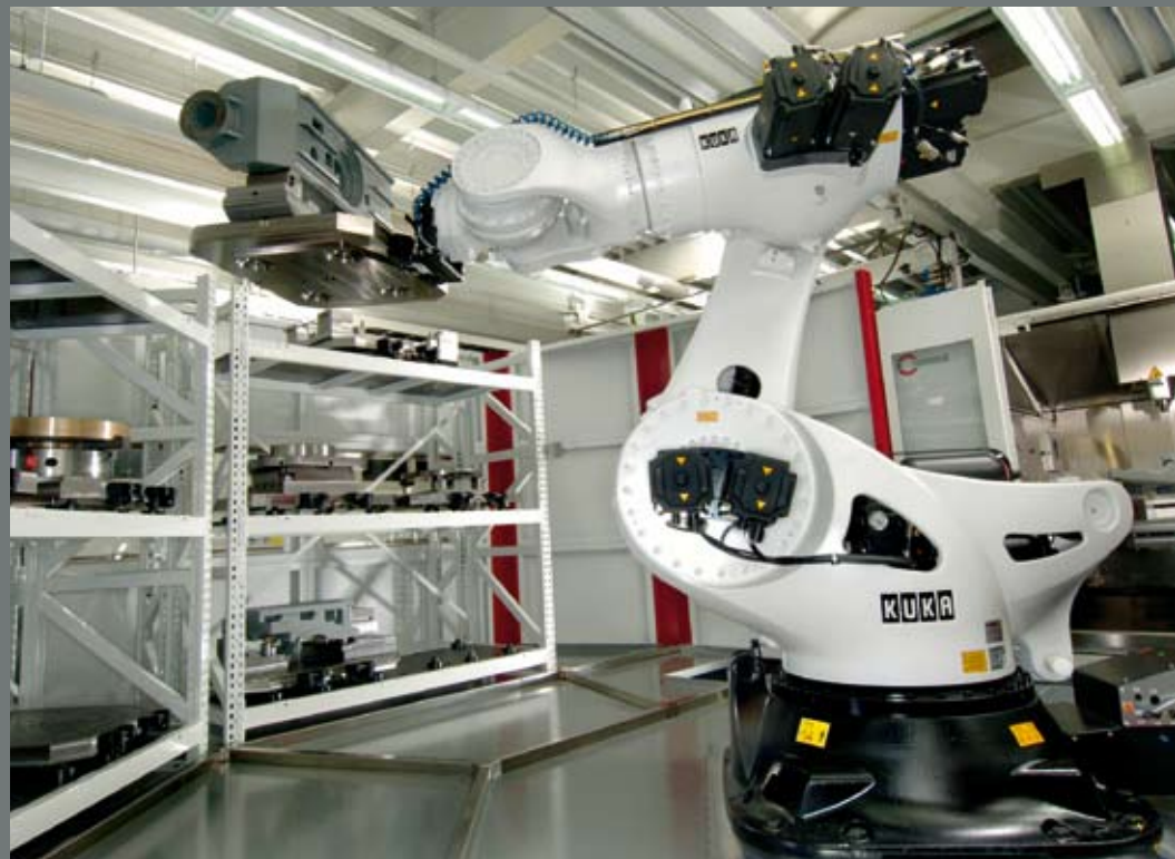
Flexibles Fertigungssystem RS 4 mit 1000 kg Transportgewicht
