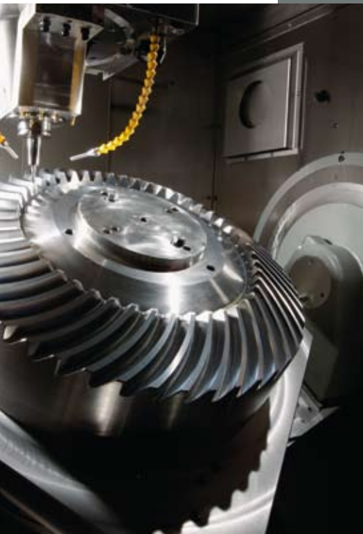
Wirtschaftliche Zahnradsfertigung auf 5-Achs-Bearbeitungszentren
